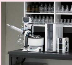
ガラスセットを装置の左右どちらでも取付け可能です。セッティング時に実験台のスペースや利き手を考慮して装置を設置することができます。
