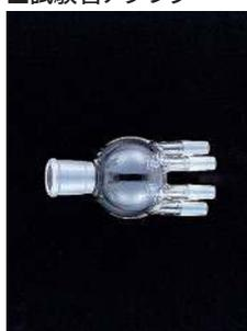
小型ロータリーエバポレーターに試験管6本を取付けるためのアダプターです。少量試料の濃縮や、ドーピング検査に適しています。
