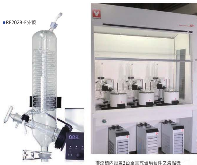
排煙櫃內設置3台垂直式玻璃套件之濃縮機
